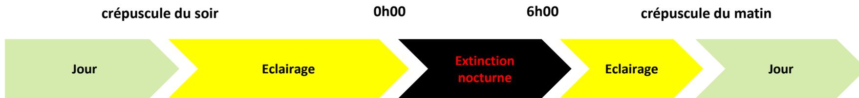
**Utilisation du contact sec du compteur** pour piloter l'allumage et l'extinction (principe du ballon d'eau chaude chez les particuliers) : nécessitant **la pose de 2 files pilotes** dans le coffret du compteur
